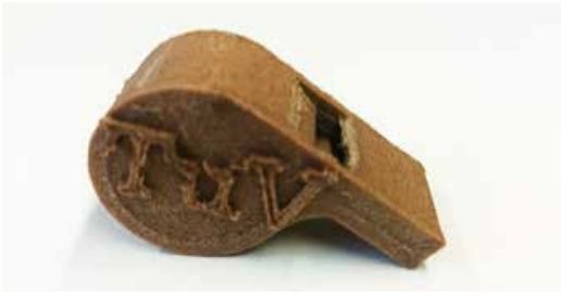
Kuva 1. Puumuovikompositista 3D tulostettu pilli.
