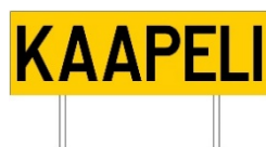
Figur 36. Kabel- och ledningstavlor
