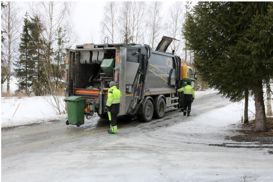
Kuvassa monilokeroinen pakkaava jäteauto vaatusjärjestelmällä punnitsee ja tyhjentää omakotikiinteistöillä syntyneet ja lajitellut jätteet omiin osastoihinsa.
